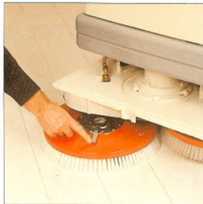
Das Bürstenzubehör läßt sich ohne Werkzeug mühelos wechseln.
